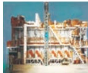
2階建AL鋳物T6熱処理炉
